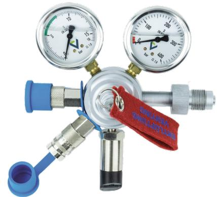
Der verbleibende Atemluftvorrat kann jederzeit am Hochdruckmanometer abgelesen werden. Das Mitteldruckmanometer zur Anzeige des Arbeitsdrucks signalisiert durch Zeigerbewegungen die Atemtätigkeit des Geräteträgers. Zusätzlich bietet der Druckminderer die Möglichkeit, das Abblaseventil auch manuell zu betätigen. So kann auch bei geschlossenem Flaschenventil das komplette System entlüftet werden.
